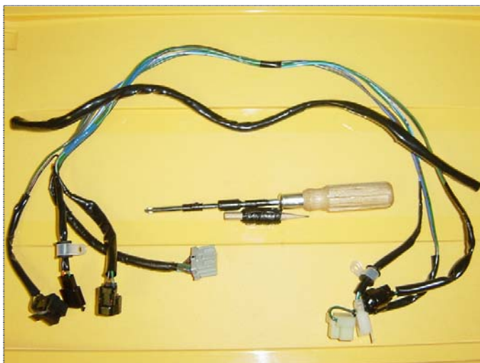
Cablaggio del musetto originale denudato.
